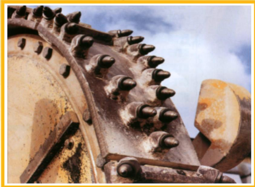
Траншейные резцы используются для оснащения машин для подземного строительства, фрезерных канавокопателей на колесном и гусеничном ходу для прокладки кабеля и рытья каналов, прокладки телекоммуникаций, водоводов и отвода сточных вод
