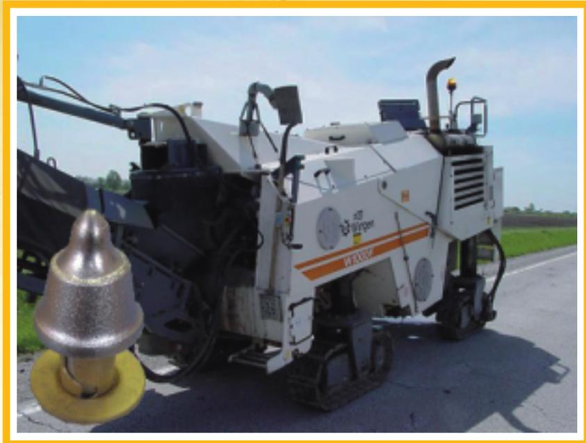
Резцы дорожно-фрезерные предназначены для оснащения фрез машин холодного фрезерования асфальтовых и бетонных покрытий
