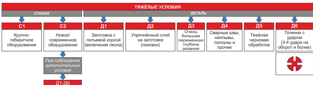
При ТЯЖЁЛЫХ условиях обработки, закрепление ПРИСПОСОБЛЕНИЯ и ИНСТРУМЕНТА по умолчанию жёсткое.
