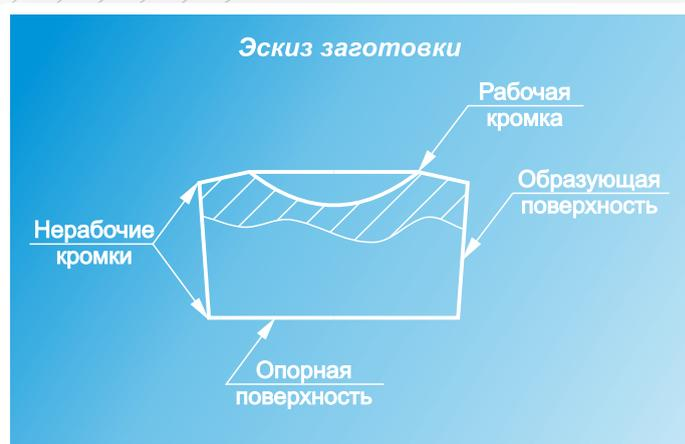
Для изготовления матриц АВД, которые подвергаются воздействию значительных растягивающих напряжений, и которые должны сохранять работоспособность при наличии пластических деформаций, возникающих в процессе эксплуатации, целесообразно использовать крупнозернистые вольфрамокобальтовые сплавы с содержанием кобальта 6%.
